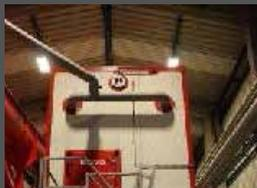
7. beim ABV-WESTTIROL noch zusätzlich aerobe Rotteboxen für den fast fertigen Kompost für 14 Tage bei 70 Grad Celsius
